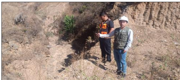
Tramo de la quebrada con alto grado de erosión en las márgenes, evidenciando socavación y posible riesgo de desmoronamiento de
